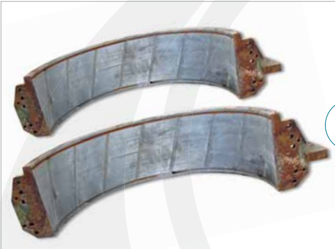
Lager vor der Reparatur
