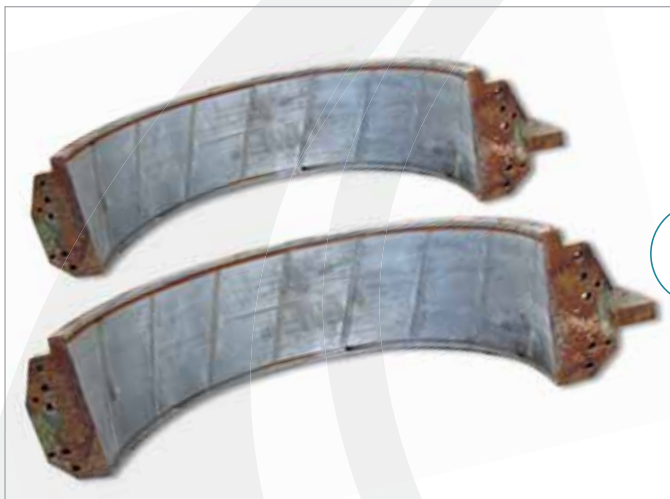
Stanje ležaja prije popravka
